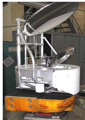
Рис. 4. СВЧ-радиометр МТВЗА-ГЯ КА «Метеор-М» №1
