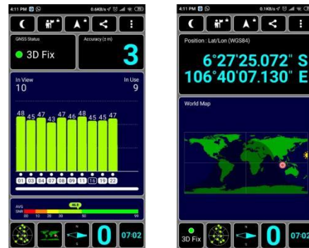
Рис. 10. Ложные координаты при GPS-тестировании (вне помещения)
