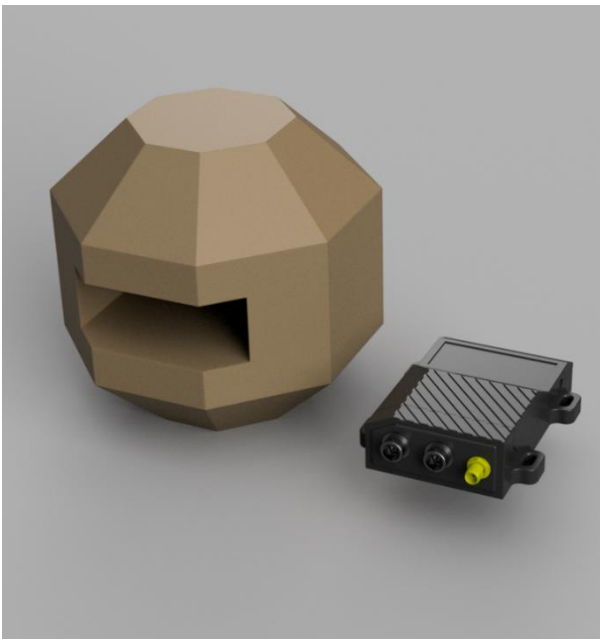
Рис. 2. Оснастка калибровки датчиков инерциальной системы навигации
