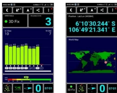
Рис. 9. Ложные координаты GPS-теста (в помещении)
