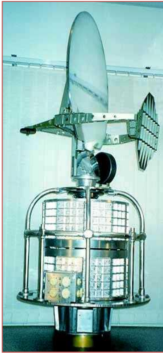
Рис. 3. Антенный модуль СВЧ-радиометра МТВ3А КА «Метеор-3М»
